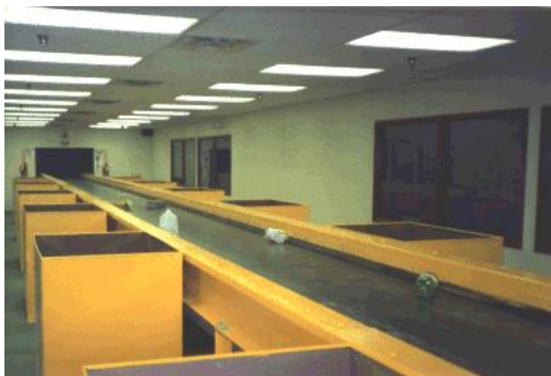
Εικόνα 10.6 Γραμμή χειροδιαλογής πλαστικού.
