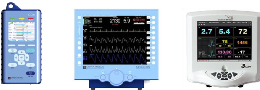
Εικόνα 1.4 ICON, Aesculon και NICOM: Συσκευές μη αιματηρής μέτρησης της καρδιακής παροχής βασισμένες στην απλή και στην επαγωγική ηλεκτρική αντίσταση (bioimpedance και bioreactance, αντίστοιχα).
