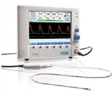
Εικόνα 1.3 CardioQODM. Συσκευή μέτρησης καρδιακής παροχής μέσω οισοφαγικού Doppler.
